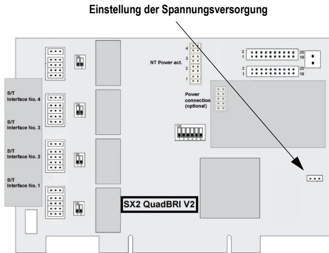
Abbildung 7 PCI-Bus Spannungsversorgung der SX2 QuadBRI
